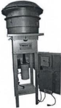
ຮູບເຄື່ອງເກັບຕົວໄຮໂວລຸມ ແລະ ຊຸດຫົວຄັດຂະໜາດຝຸ່ນລະອອງຂະໜາດບໍ່ເກີນ 10 ໄມຄຣອນ (PM 10 ).
