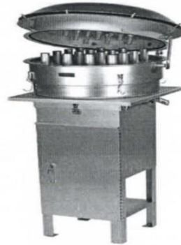
ຮູບເຄື່ອງເກັບຕົວໄຮໂວລຸມ ແລະ ຊຸດຫົວຄັດຂະໜາດຝຸ່ນລະອອງຂະໜາດບໍ່ເກີນ 2.5 ໄມຄຣອນ (PM 2.5 )
