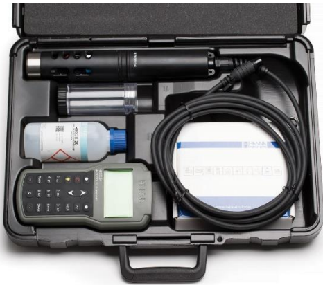
ຮູບຕົວຢ່າງເຄື່ອງວັດແທກຄຸນນະພາບນໍ້າພາກສະໜາມ
