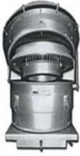
ຮູບເຄື່ອງເກັບຕົວໄຮໂວລຸມ ແລະ ຊຸດຫົວຄັດຂະໜາດຝຸ່ນລະອອງຂະໜາດບໍ່ເກີນ 10 ໄມຄຣອນ (PM 10 ).
